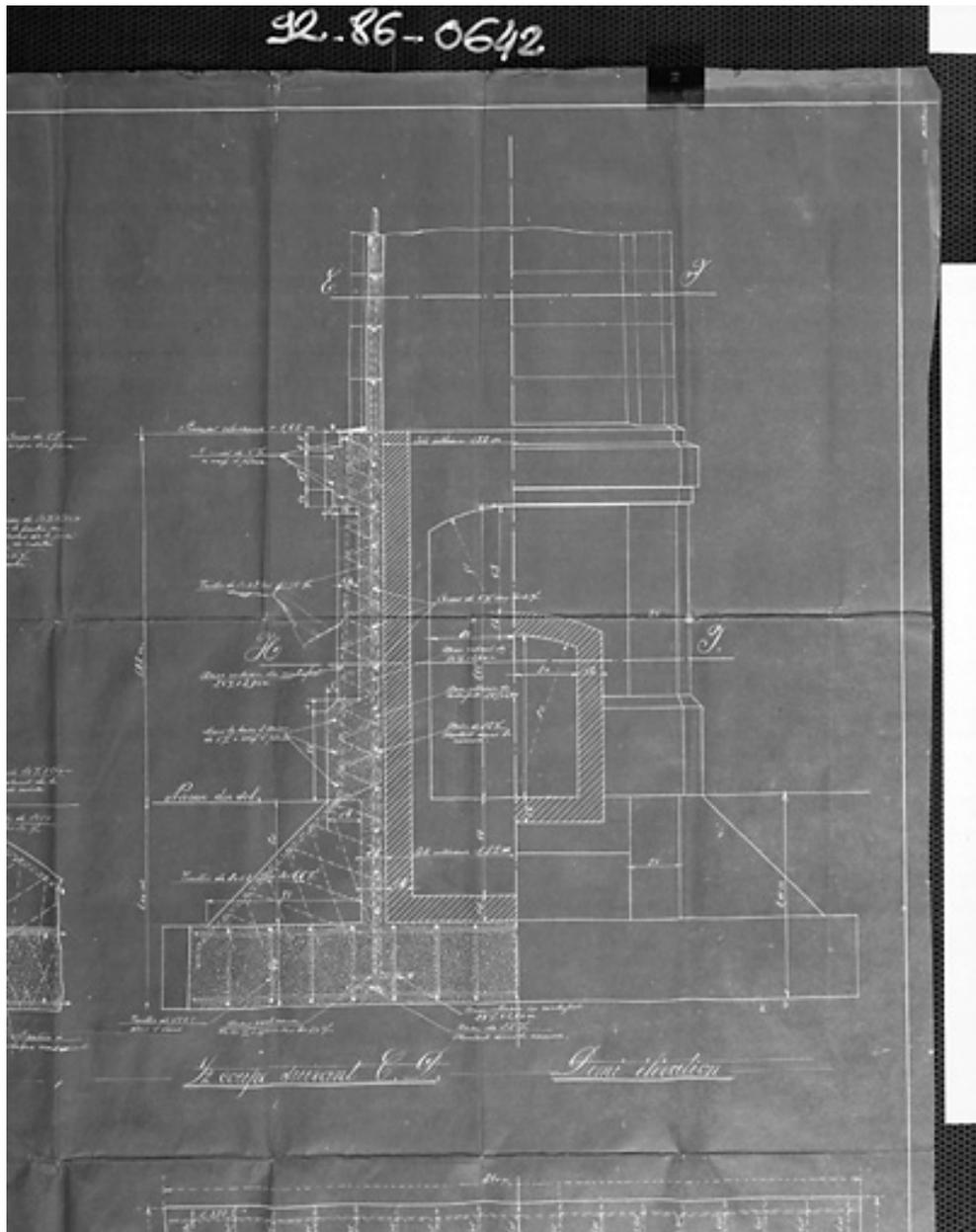
Cheminée en béton, 1909, demi élévation de la base.
