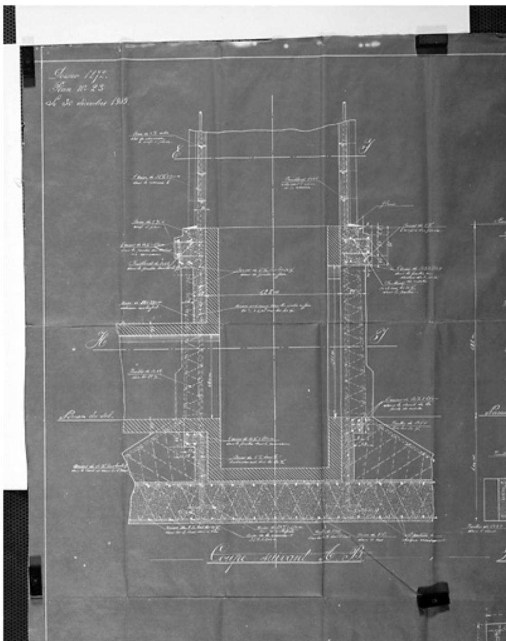
Cheminée en béton, 1909, coupe, élévation de la base.
