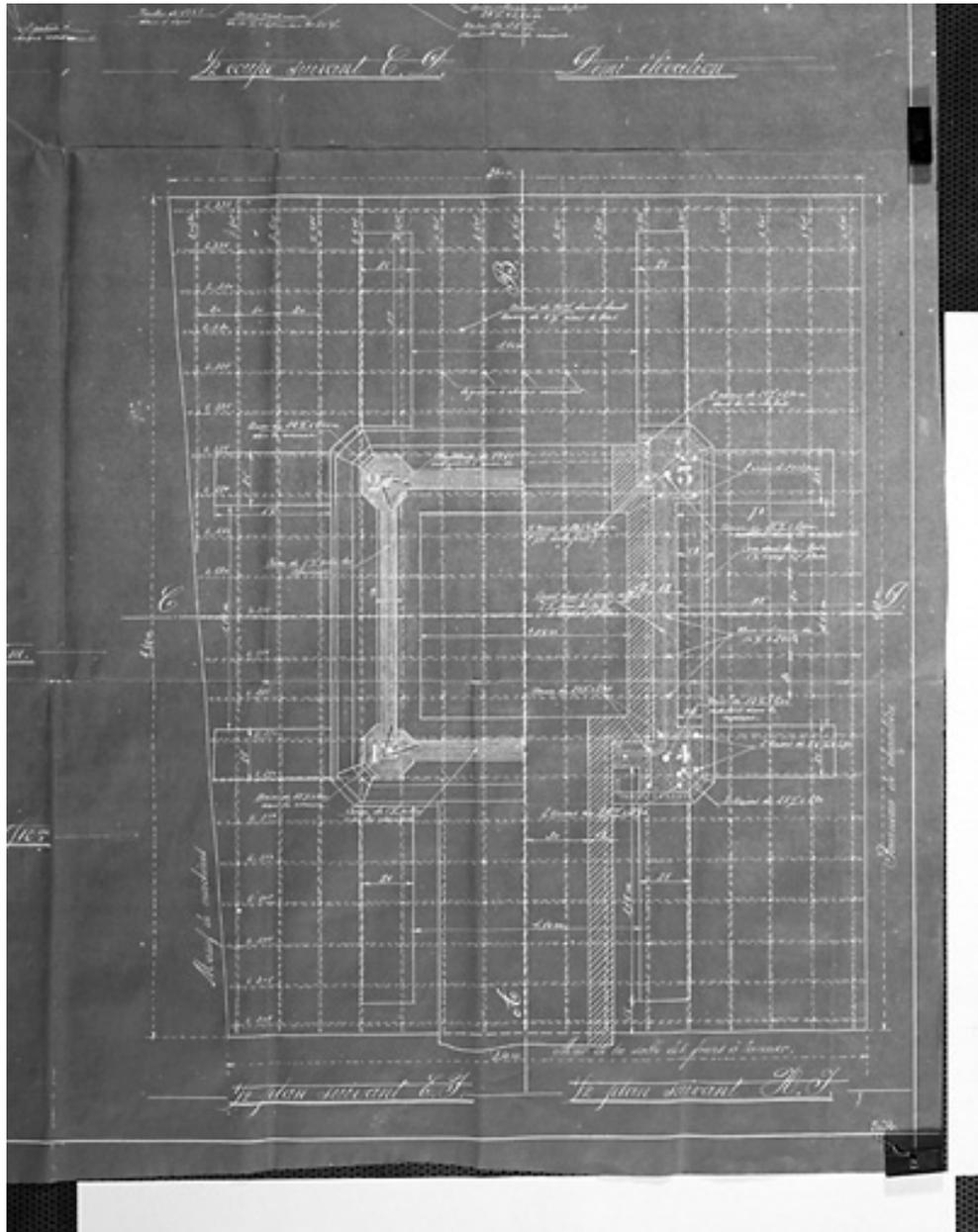
Cheminée en béton, 1909, plan des ferraillages et des fondations.
