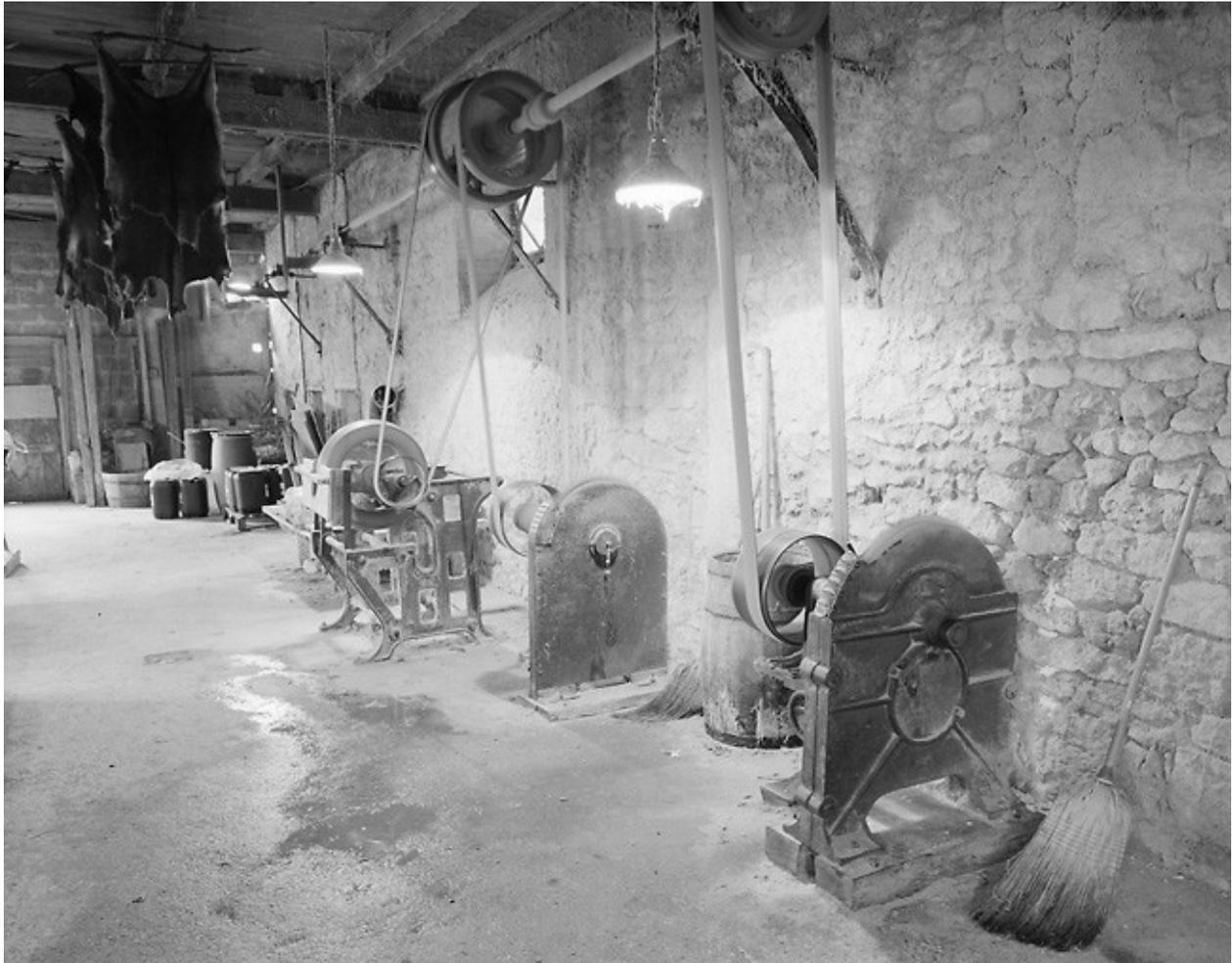
Intérieur, machines de finition, meule de finition, doleuses.
